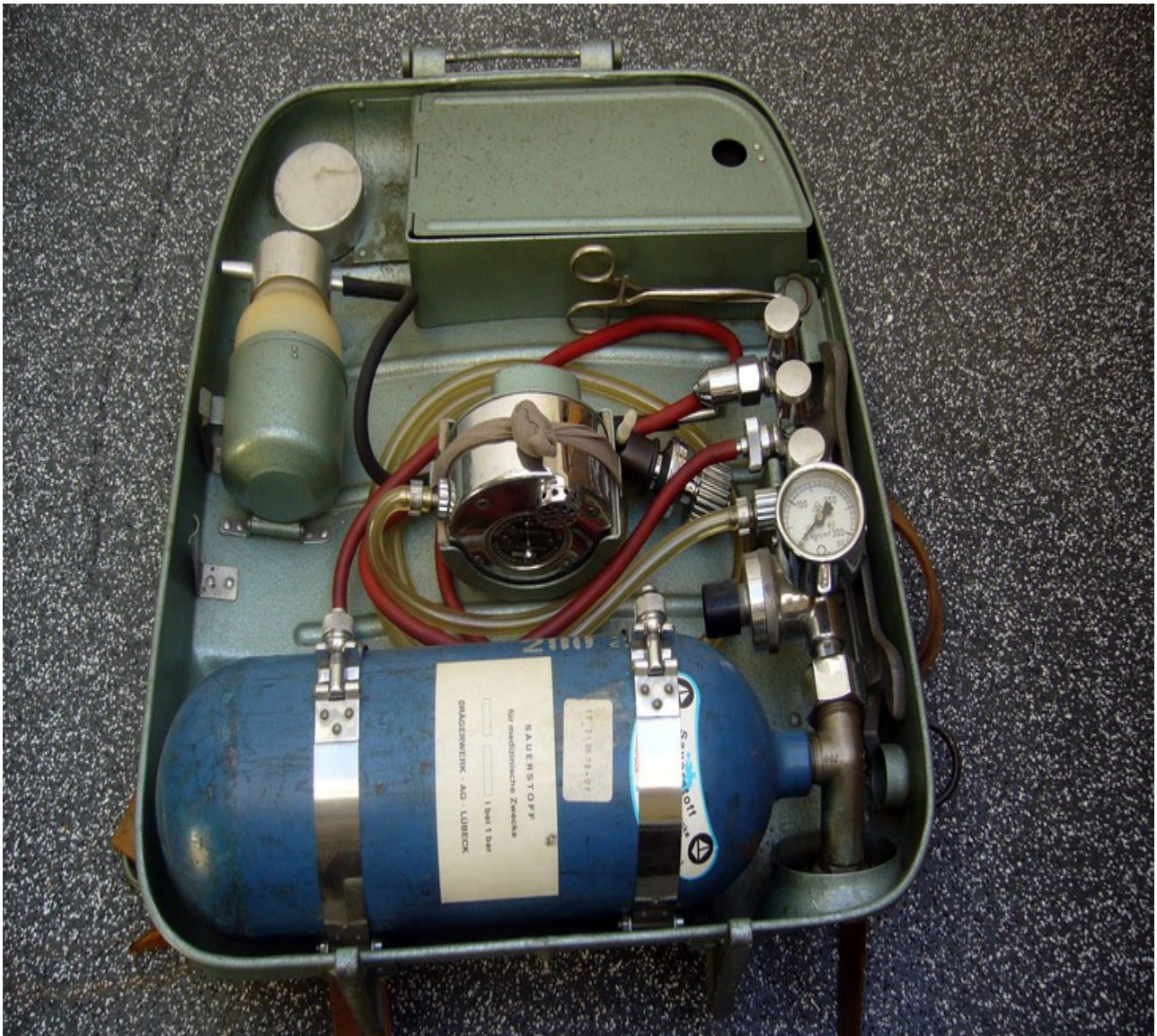
Instrumentarium zur Rettung von verschütteten Bergleuten: Koffer mit Beatmungsgerät (DRK KV Essen)
